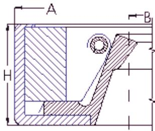
Anello di tenuta olio per alberi rotanti sviluppato per ambienti operativi particolarmente difficili dell'industria pesante. La combinazione molla a pettine - molla a spirale garantisce le performance dell'anello anche in presenza di alte velocità e importanti disassamenti tra cilindri e tenute
