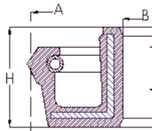
Anello di tenuta olio con supporto metallico in acciaio e molle toroidali di aderenza, interamente ricoperto da elastomero. L'anello DRATE a tenuta esterna viene impiegato quando non è l'albero ad avere il moto rotatorio ma la sua sede. Temp. Max 120°C, pressione fino a 1 bar
