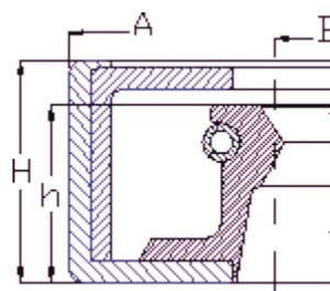
Anello di tenuta olio per alberi rotanti simile al tipo DRB1 ma con doppio scatolino metallico esterno per garantire maggiore robustezza dell'anello e proteggere il labbro di tenuta. **Fornibile nella versione con parapolvere (DRCS)**
