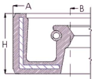
Anello di tenuta olio per alberi rotanti con supporto metallico in acciaio e molla toroidale di aderenza, interamente ricoperto da elastomero. E' particolarmente adatto per applicazioni ad elevato numero di giri, temp. max 120°C e pressioni fino a 1 bar. **Fornibile nella versione con parapolvere (DRAS)**
