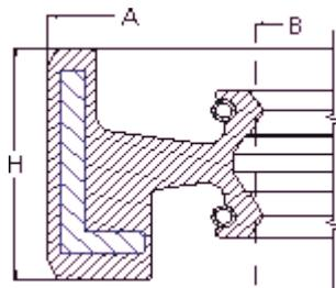
Anello di tenuta olio per alberi rotanti con supporto metallico in acciaio e molle toroidali di aderenza, interamente ricoperto da elastomero. E' particolarmente adatto per applicazioni in cui sia necessario garantire la tenuta per due fluidi diversi con temp. max 120°C e pressioni fino a 1 bar.
