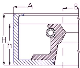
Anello di tenuta olio per alberi rotanti con scatolino metallico esterno rettificato o calibrato. Lo scatolino metallico previene il rapido invecchiamento della gomma esterna che può verificarsi sul tipo DRA nel caso l'anello venga fatto lavorare ad una temperatura vicina ai limiti per un lungo periodo di tempo
