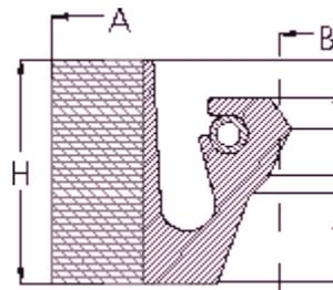
Anello di tenuta olio senza supporto metallico con un robusto dorso in gomma-tela e labbro di tenuta in elastomero. Viene fornito principalmente nella versione tagliata (split) che ne consente l'impiego dove sia difficoltoso lo smontaggio del cilindro.
