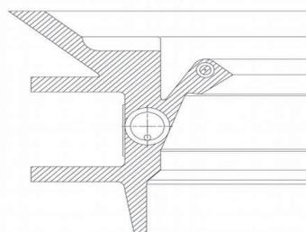
Anello di tenuta speciale per impiego con cuscinetti a velo d'olio: vengono utilizzati principalmente sui cilindri di appoggio nella laminazione a caldo o a freddo. La molla a spirale è completamente vulcanizzata all'interno del labbro per evitare il pericolo di fuoriuscita della stessa durante l'assemblaggio o il lavoro. La miscela utilizzata permette alla guarnizione di resistere a temp. fino a 160°C
