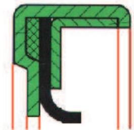
Anello di tenuta olio per alberi rotanti con scatolino metallico esterno in acciaio inox, labbro di tenuta in PTFE caricato e guarnizione elastomerica. E' idoneo per pressione fino a 5 bar ed elevate velocità di rotazione dell'albero con media o scarsa lubrificazione in quanto il labbro presenta scarso attrito ed è privo di stick-slip. **Fornibile anche nella versione con doppio labbro per pressioni più elevate e guarnizione interna in FKM.**
