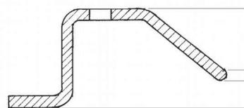
Guarnizione sagomata in alluminio impiegata come sostegno dell'anello Rotec-Oil. Disponibile con diametri da 42" a 56"
