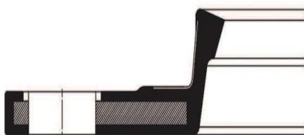
Anello di tenuta speciale paracqua utilizzato per impedire infiltrazioni di acqua nei cilindri d'appoggio nella laminazione a caldo o a freddo. La miscela utilizzata permette alla guarnizione di lavorare in un range di temperatura tra -40°C e +160°C. L'anello può essere fornito con o senza molla a pettine in acciaio inox.
